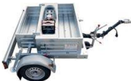
particolare cassone alloggiamento per batteria e caricabatteria
