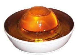
Dispositivo retroriflettente integrativo dei segnali orizzontali in vetro temperato da fissare nella carreggiata per incastro con uso di collante (bitume ossidato a caldo o resina ad applicazione a caldo o a freddo).
